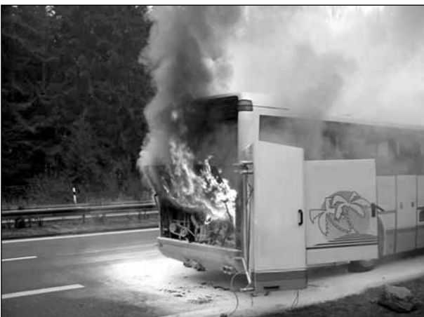
Bild 2.26: Motorvollbrand nach Öffnen der heckseitigen Motorhaube, Zeit: 00:05
