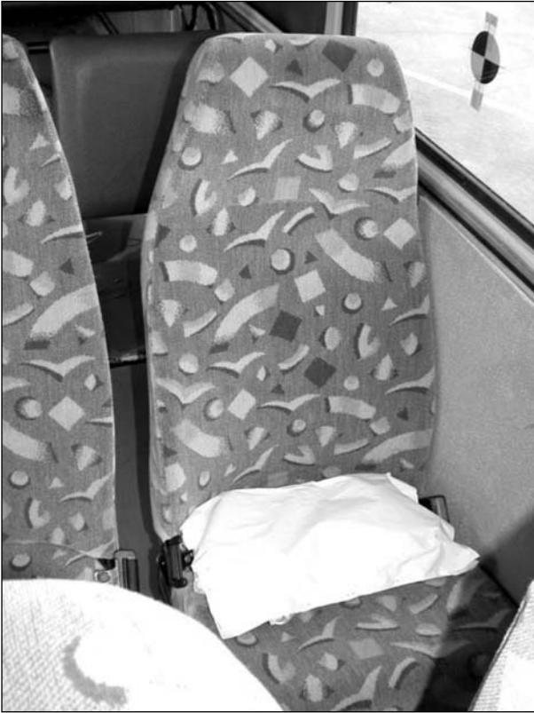
Bild 12.7: Positioniertes Papierkissen (DIN 54341), Versuch 1
