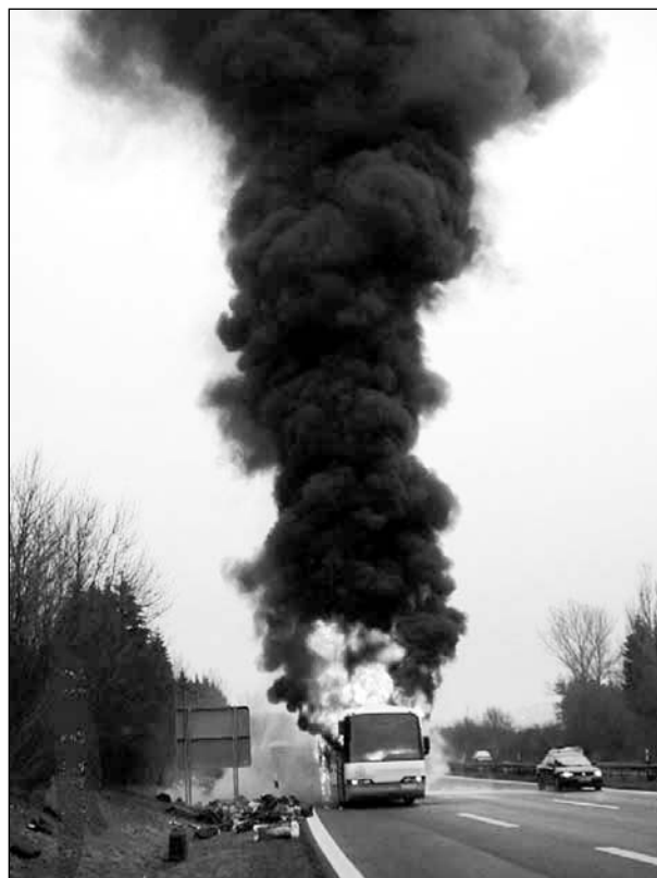
Bild 2.32: Flammenaustritt zur vorderen Tür, sichtbare Flammen hinter der Windschutzscheibe, Zeit: 00:13
