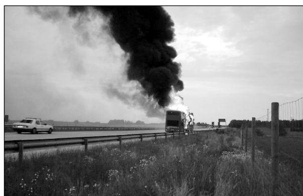
Bild 2.11: Flashover mit anschließendem Vollbrand des Busses auf beiden Geschossen
