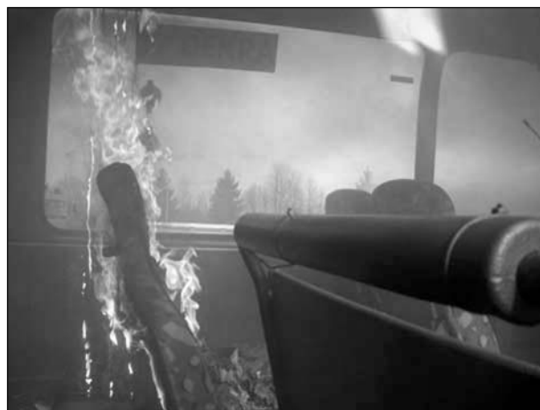
Bild 12.19: Brennendes Abtropfen der Gepäckablage
