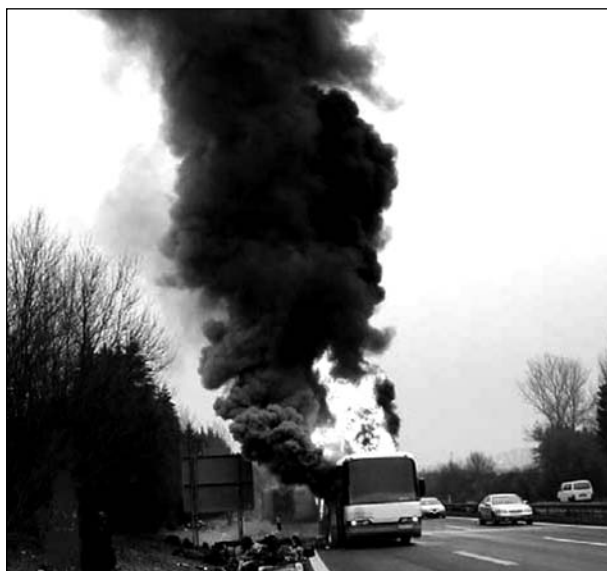
Bild 2.31: Bildung großer Mengen schwarzen Rauchs durch Temperaturerhöhung und Sauerstoffmangel im Bus, Zeit: 00:11
