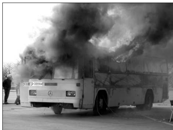
Bild 12.27: Flashover, gesehen von der linken Fahrzeugseite
