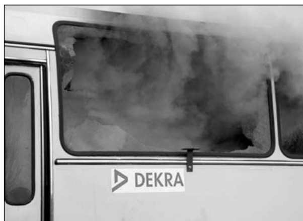
Bild 12.28: Durch Flashover zerstörte Seitenscheibe
