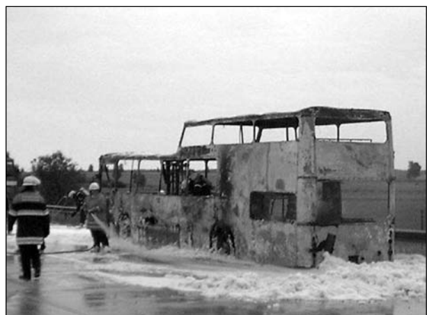
Bild 2.18: Ausgebrannte Karosserie nach Abschluss der Löscharbeiten, komplett ausgebrannte Innenausstattung, linke Seite
