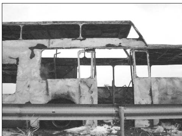
Bild 2.20: Bereich des ersten Brandeintritts in den Innenraum an der Hecktüre nach Abschluss der Löscharbeiten, der Boden des Obergeschosses ist komplett weggebrannt
