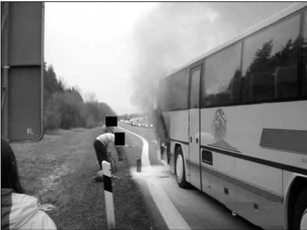
Bild 2.24: Weitere Löschversuche mittels zweier 6-kg-Feuerlöcher, bereitgestellt von einem vorbeikommenden Lkw-Fahrer, Zeit: 00:03
