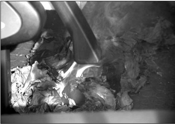
Bild 12.13: Brand des Fußbodens unter starker Rauchentwicklung
