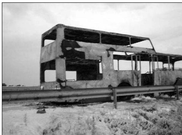
Bild 2.19: Ausgebrannte Karosserie nach Abschluss der Löscharbeiten, komplett ausgebrannte Innenausstattung, rechte Seite
