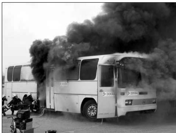
Bild 12.26: Flashover mit Zerplatzen der Seitenscheibe
