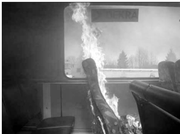
Bild 12.17: Versuchssitz nach Zündung
