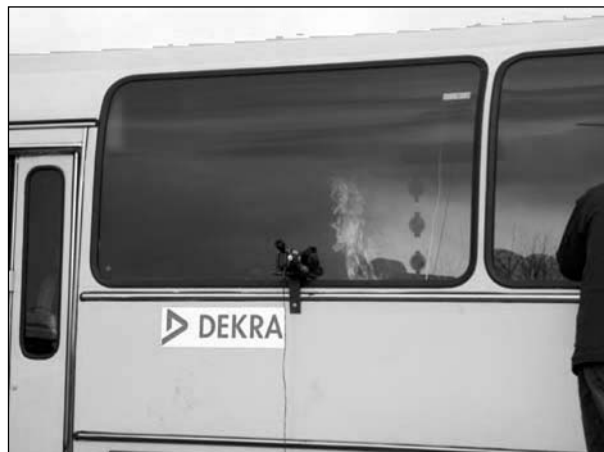
Bild 12.20: Deutliche Rauchschichtenbildung im Bus
