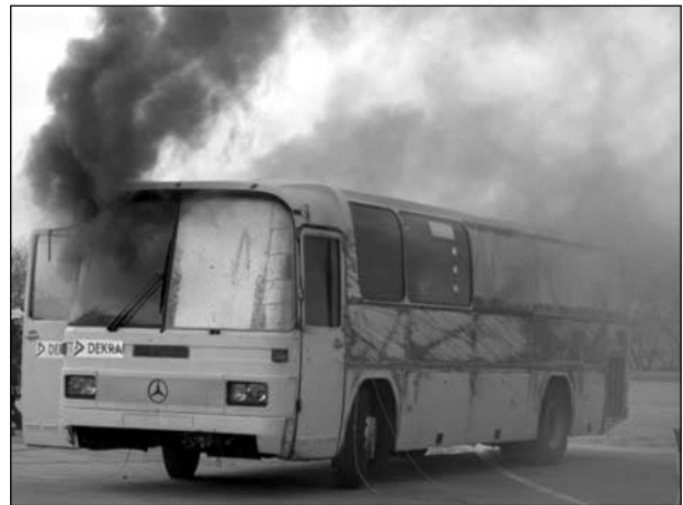
Bild 12.24: Verstärkter Rauchaustritt, konstante Branderscheinung am Sitz
