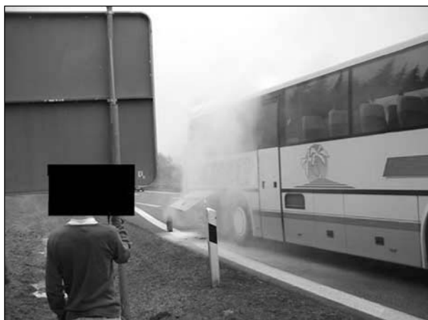
Bild 2.21: Rauchentwicklung im Motorraum, Evakuierung abgeschlossen, leichter Flammenschein sichtbar, Zeit: 00:00
