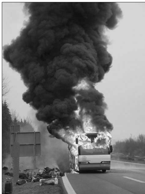
Bild 2.34: Weiteres Absinken der Flammenaustrittsfront in der Windschutzscheibe, unvermindert starke Flammenbildung in der Rauchphase über dem Bus, Zeit: 00:13
